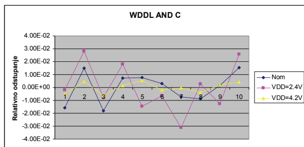
Sl.5 Poređenje relativnog odstupanja energije od srednje vrednosti za WDDL AND C ćeliju za različite vrednosti napona napajanja
